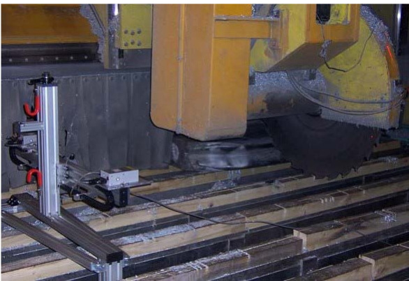
图一：安装了Dimetix激光测距传感器的龙门锯
