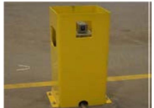
图二：系统中嵌入Dimetix激光测距传感器
