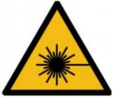
用光学设备(双筒望远镜、望远镜)直接观察光束可能是危险的。
