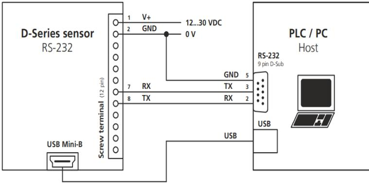
RS-232 或 USB 接口的规格在 5.7 RS-232 接口或 3.10 USB 接口中描述。使用 RS-232 或 USB 接口进行配置的连接如图 24 所示。
