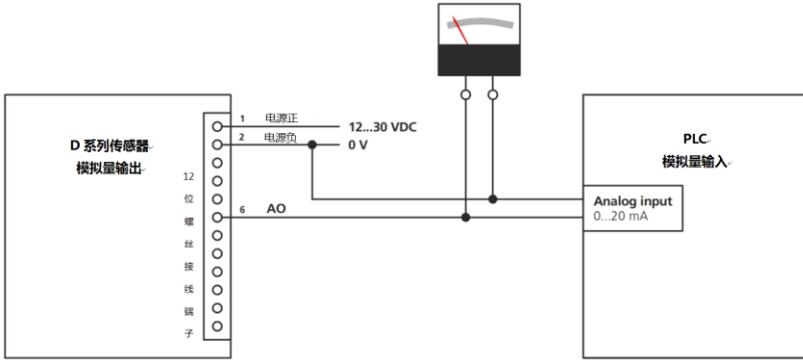
图 16:模拟输出与 PLC(或其他设备)的连接
