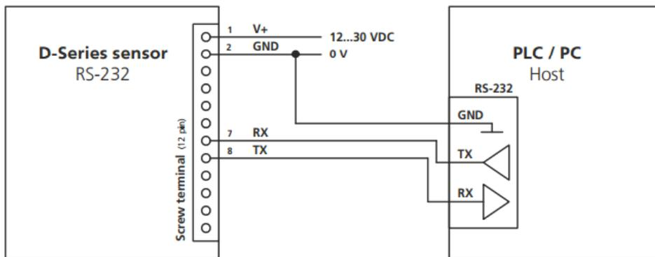
图 17:RS232 接口的连接
