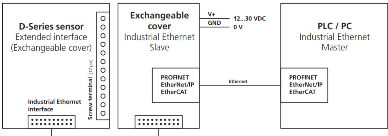
图 23:工业以太网接口交换盖的连接
