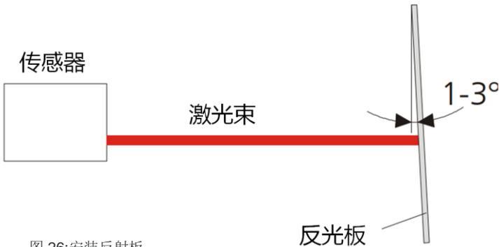
图 26:安装反射板
